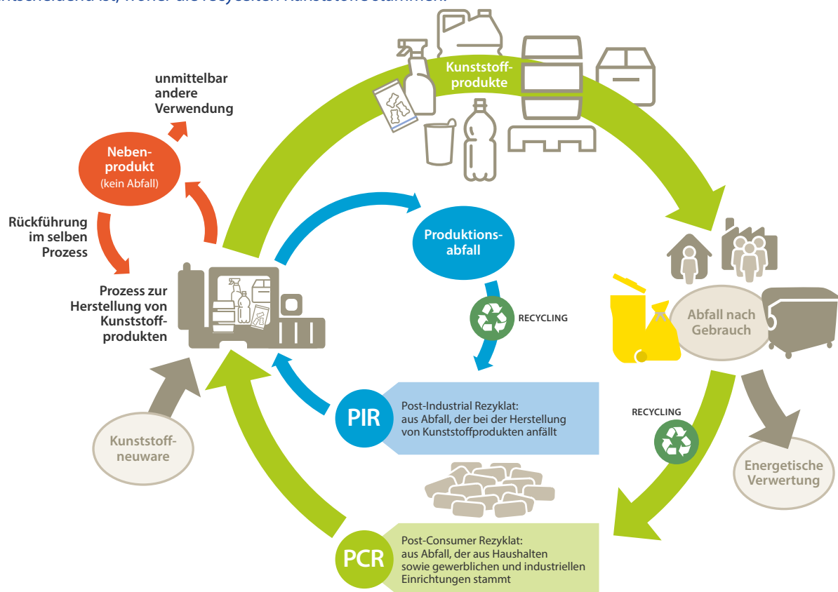
Abbildung 1: Unterschied zwischen Post-consumer-Rezyklat und Post-industrial-Rezyklat und Nebenprodukt
