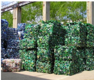
PET-Pfandflaschen sortiert und zu Ballen gepresst
