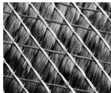
Produktionsreste des Verbundwerkstoffs
