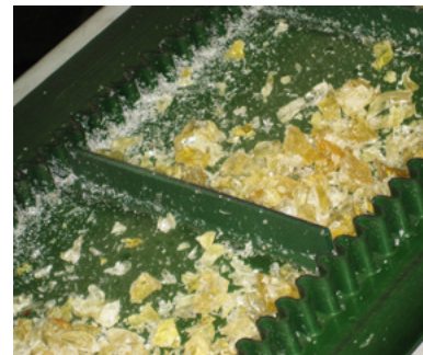
Grob zerkleinerte Brocken und Stränge
