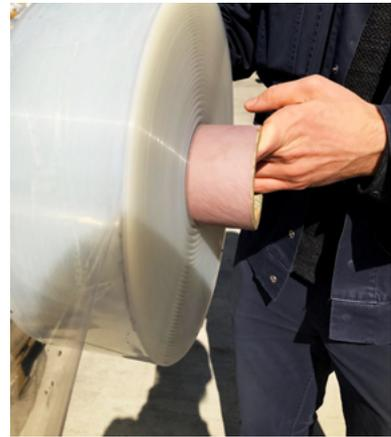
*Fehlerhafte Produktion, Folienausschuss / Abschnitt aus Produktion; Gemisch PA/PE*
