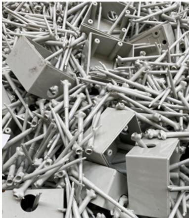
*Fehlerhafte Produktion und Angüsse*
