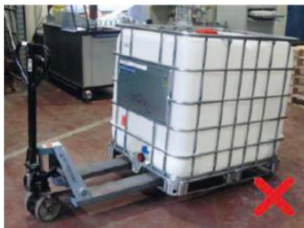
Schützen Sie den IBC vor Stößen. Schützen Sie außerdem die Armatur vor Schäden. Verwenden Sie niemals an den Traversen oder dem Gitter angebrachte Ketten, um den IBC zu bewegen. Wegen alternativer Transportmöglichkeiten setzen Sie sich bitte mit Ihrem Lieferanten in Verbindung.
